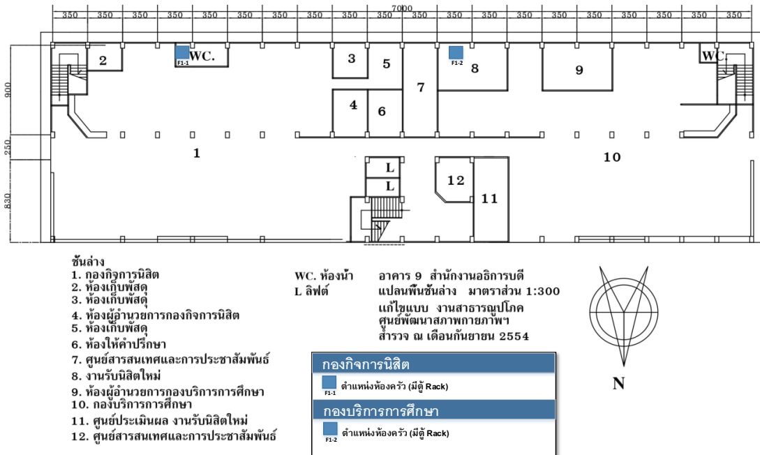
รูปภาพ 54 : แผนผังปรับปรุงตำแหน่งอุปกรณ์กระจายสัญญาณสวิตช์กองบริการการศึกษา (ชั้น 1)
