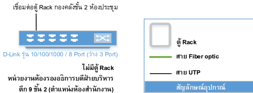
รูปภาพ 33 : ตู้ Rack และอุปกรณ์กระจายสัญญาณสวิตช์ห้องรองอธิการบดีฝ่ายบริหาร (ชั้น 2)
